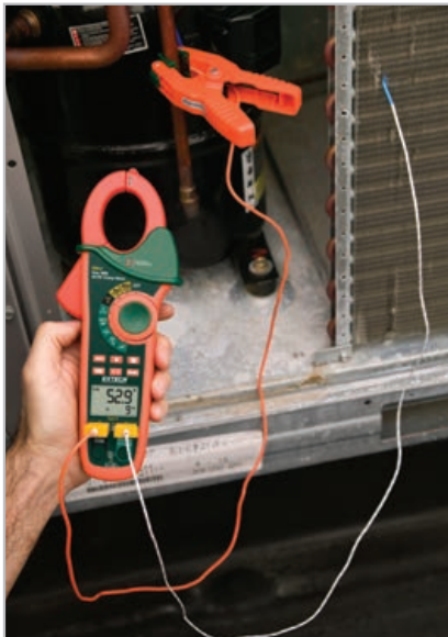
Entradas dobles tipo K para realizar lecturas de temperatura diferencial para mediciones de sobrecalentamiento.
